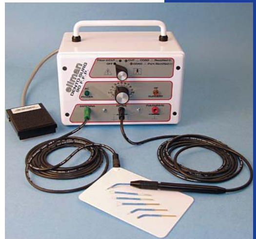
Рис. 1. Запатентованный высокочастотный и низкотемпературный радиоволновой генератор с монополярным и биполярным режимами
